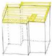
Abbruch Drempel Öffnung Decke Treppenhaus (TH)
