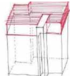
Aufstockung um zwei Geschosse
