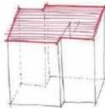
Notdach Bitumen, geschweißt
