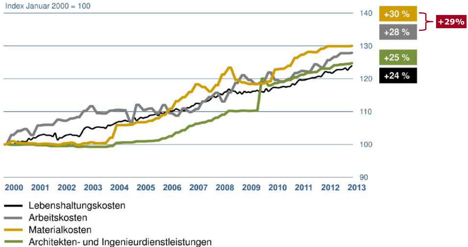
Diagramm 4: Entwicklung der Material-, Arbeits- und Planungskosten im Wohnungsbau im Vergleich zu den allgemeinen Lebenshaltungskosten
